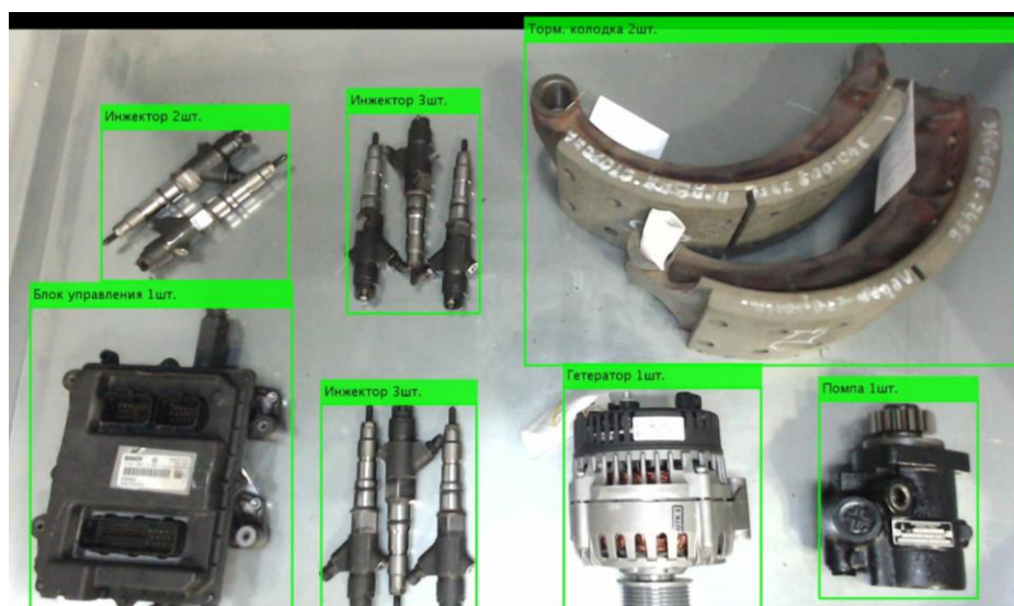
Рисунок 5. Пример работы системы - классификация и подсчет объектов
