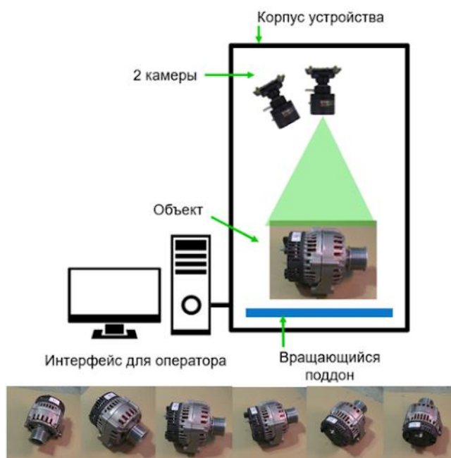
Рисунок 3. Стенд для автоматизации сбора базы изображений
